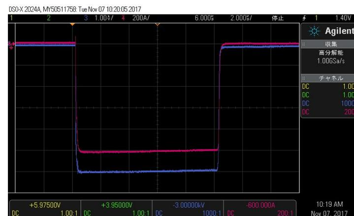
CH3 (Blue) : voltage 1kV/div 6.03kV
